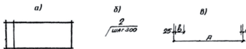
а) концептуальная схема арматурной сетки; б) выноска с присоединёнными параметрами: позицией стержня и шагом стержней данной позиции; в) размеры с присоединёнными числовыми и символьными параметрами
