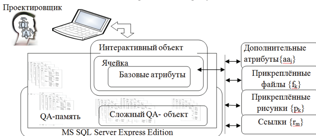
Рисунок 7 – Структура ячейки QA-памяти моделирующей среды WIQA
